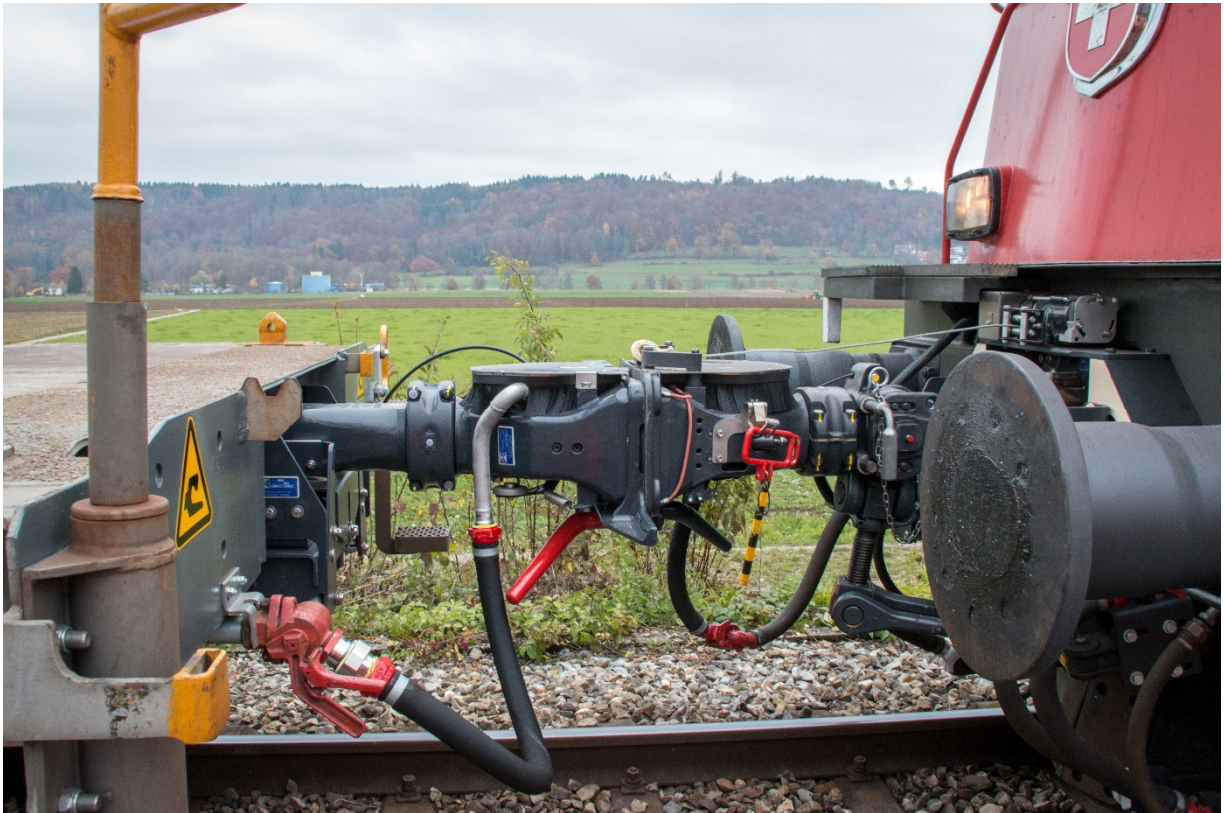
Die digitale automatische Kupplung (DAK) an einem Testzug der SBB
